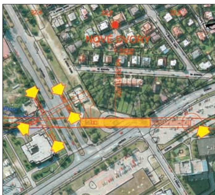
STANICE NOVÉ DVORY – Ražená stanice se dvěma vestibuly. Stanice bude plnit několik dopravních funkcí. Půjde zejména o dopravní obsluhu rozvíjejícího se sídliště i plánovaného obchodně-administrativního centra a dále o přestupy na návaznou autobusovou dopravu. Za stanicí Nové Dvory bude založeno větvení trasy metra do směru Modřany. Stanice je řešena s kolejovým uspořádáním pro obrát vlaků.
